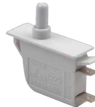
▶ FN-8 额定电压：250VAC 额定电流：0.5A 常态绝缘电阻：不小于500M 连接方式：3-2.8x0.5;寿命大于10万次；动作行程大于1mm
